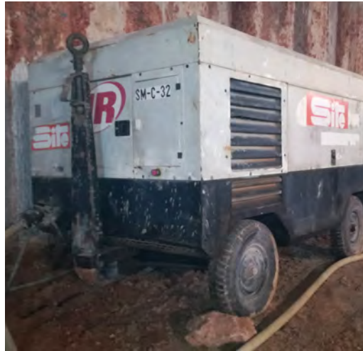
(izquierda) Perforadora de oruga horizontal. (derecha) Compresor de gasoil.
